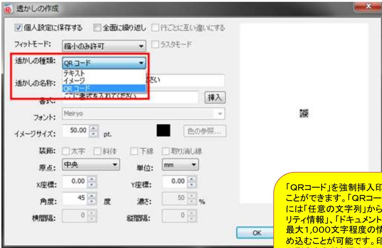
「QRコード」を強制挿入印刷することができます。「QRコード」の中には「任意の文字列」から「セキュリティ情報」、「ドキュメントID」など最大1,000文字程度の情報を埋め込むことが可能です。印刷日時、印刷者名などを埋め込んだQRコードを挿入印刷することにより、文書の偽造/改ざんなどの抑止効果を期待できます。
